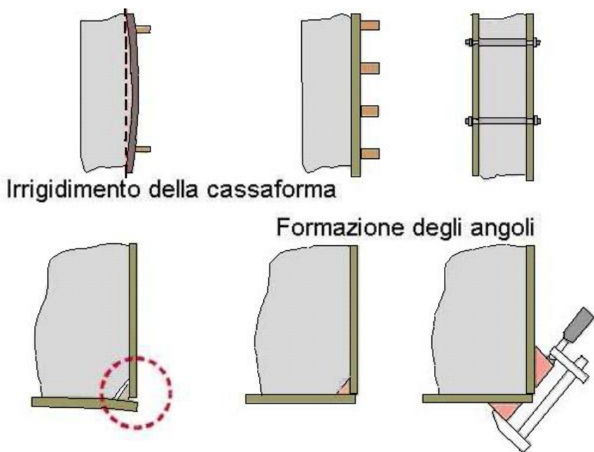
Figura 58.11 - Marcatura delle casseforme
